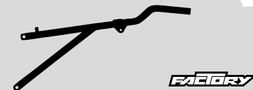
BOUCLE ARRIÈRE FACTORY FACTORY REAR SUBFRAME
