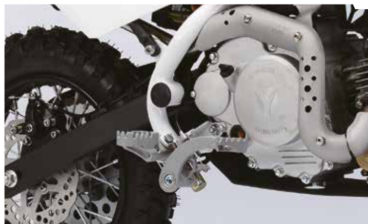
PROTECTION MÂTRE CYLINDRE FREIN ARRIÈRE POUR LITE/ START 2007-19/ PILOT/ FACTORY 2007-15 REAR BRAKE MASTER CYLINDER GUARD FOR LITE/ START 2007-19/ PILOT/ FACTORY 2007-15
