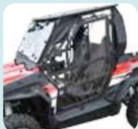
1 Cabine intégrale avec chauffage : cabine complète comprenant pare-brise avec essuie-glace + lave-vitre, toit, portes avec fenêtres coulissantes, chauffage, vitre arrière.
