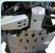
5 Protection châssis CRD Aluminium 5mm d'épaisseur, kit complet protection châssis et triangles.
