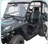
13 Cabine intégrale avec chauffage : cabine complète comprenant pare-brise avec essuie-glace + lave-vitre, toit, portes avec fenêtres coulissantes, chauffage, vitre arrière.
